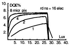
Figure 2. DQE-exposure curves: 16 electrons rms read-noise.
